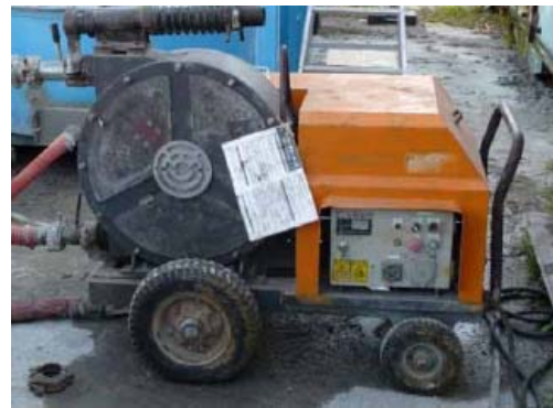
試験施工で用いた圧送ポンプ
